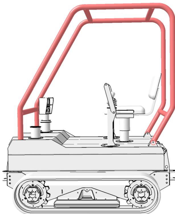
2. Комплектация **A2\*2**: шасси гусеничное тракторное с закрытой кабиной
